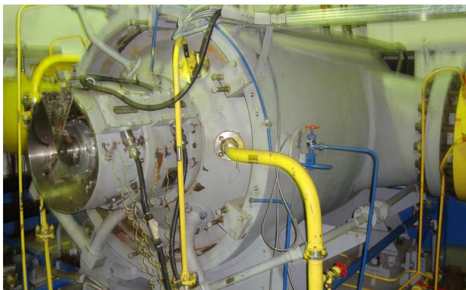
Рисунок 6 – Нагнетатель газоперекачивающего агрегата ГПА Ц-16 с электромагнитными подшипниками
