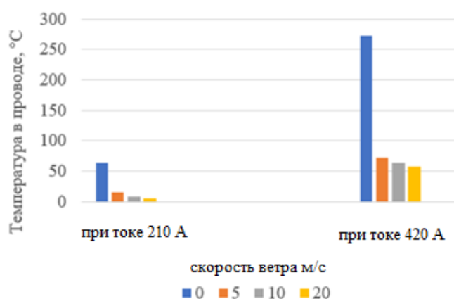
Рисунок 3.7. Диаграммы температуры в проводе при разных токах плавки гололеда.
