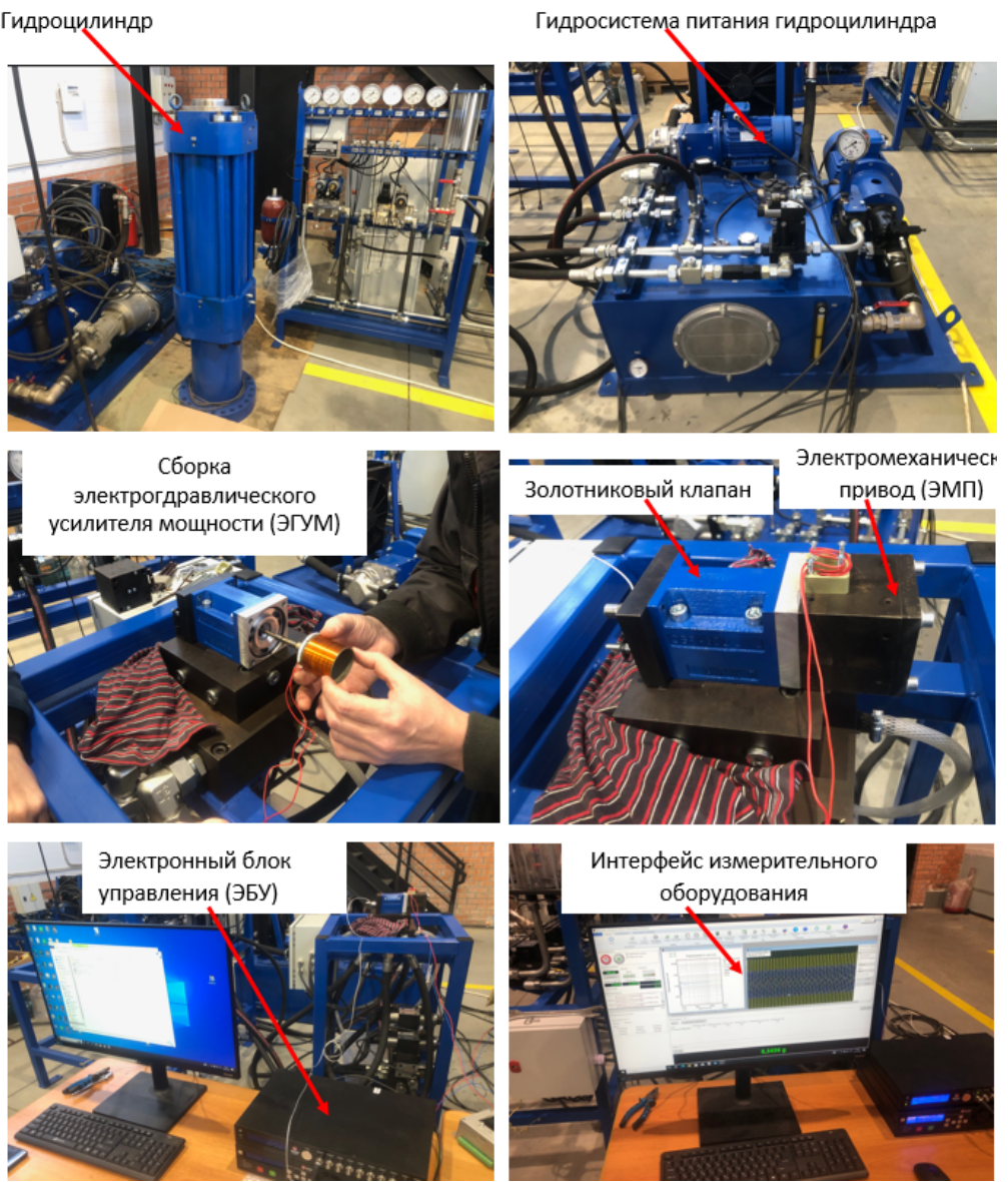
Рис.4.4.3.1. Испытание электромеханического преобразователя в составе электрогидравлического усилителя мощности
