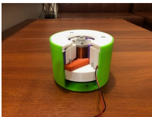
Рис.4.5.8. Имитационная модель ЭМП конструкции 3
