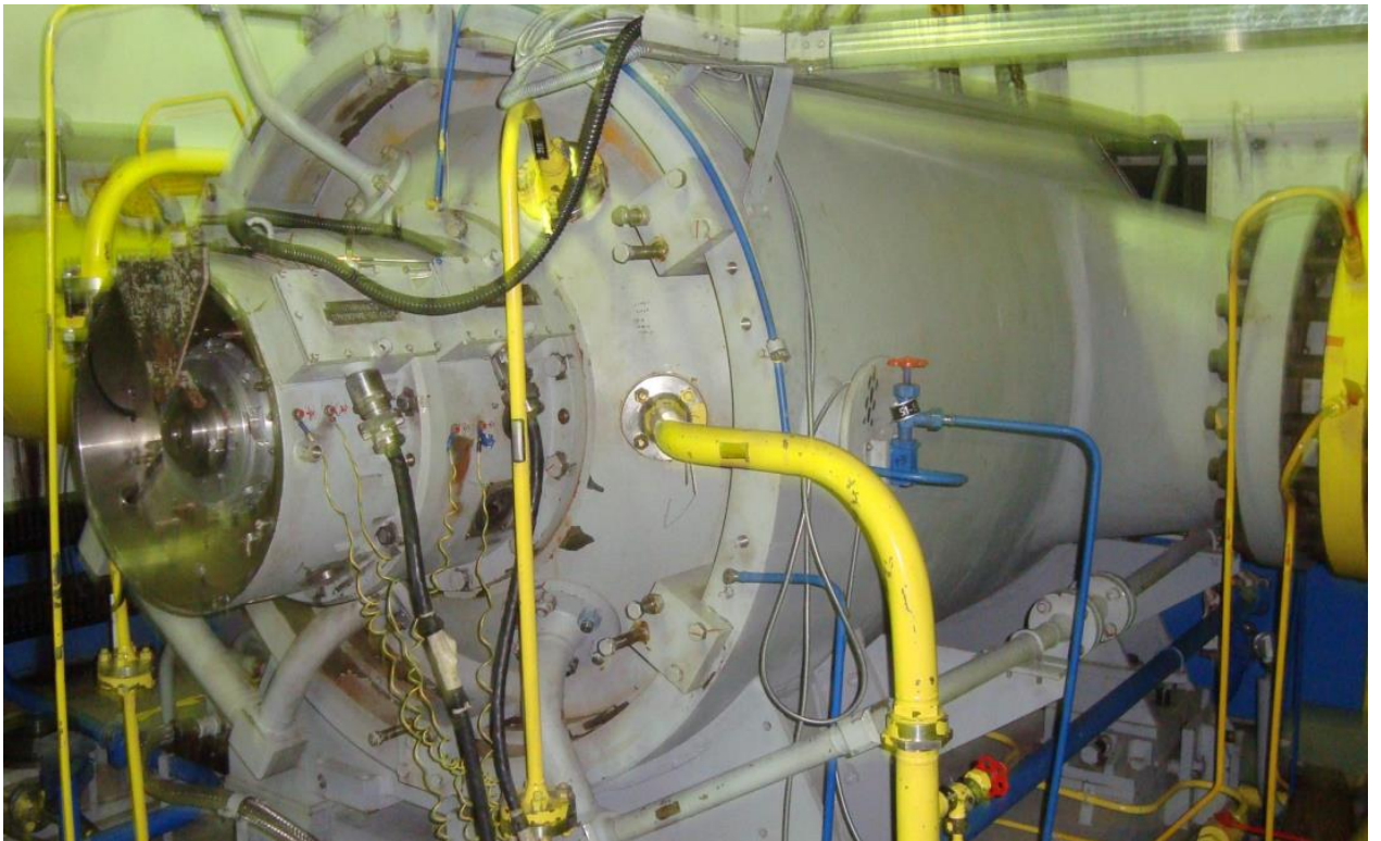
Рисунок 4.14 – Нагнетатель газоперекачивающего агрегата ГПА Ц-16 с электромагнитными подшипниками
