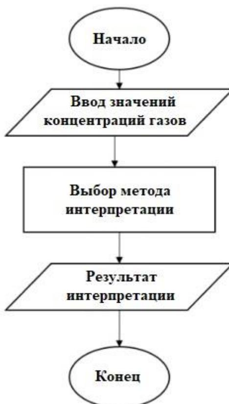
Рисунок 4.2 – Блок схема программного продукта по методу треугольника Дюваля
